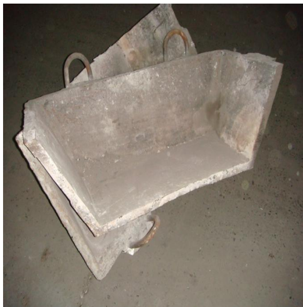
Рисунок 1 - Разрушившаяся шлаковня из чугуна с повышенным содержанием серы (>0,1 %)
