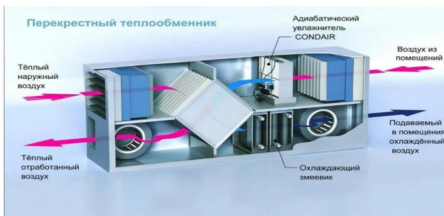
Рисунок 1 – Схема адиабатического увлажнителя
