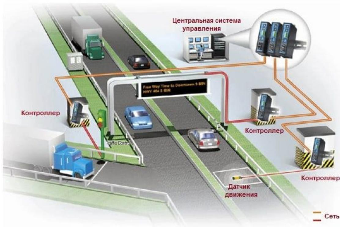
Рис.2 – Система «Умный светофор»
