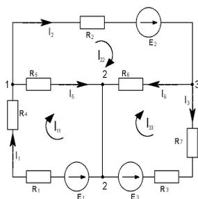
Самостоятельно задать значения источников ЭДС и сопротивления резисторов. Определить токи в ветвях любым из известных методов. Построить векторную и топографическую диаграммы. Объяснить полученный результат по диаграммам и ответить на следующие вопросы:
