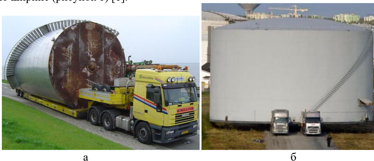
Рис. 1. Перевозка крупногабаритных грузов: а – транспортировка секции емкости; б – уникальная операция: перевозка крупногабаритной емкости с использованием двух автомобилей
