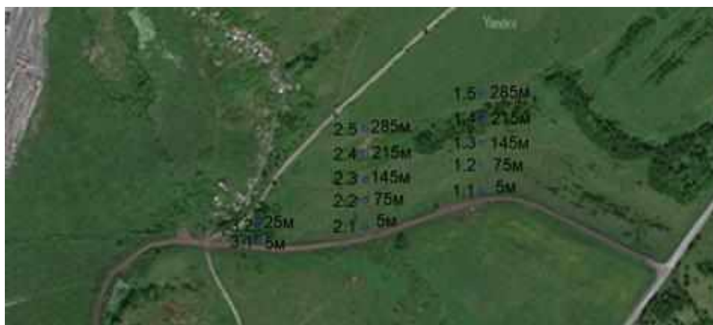
Рисунок 2.1 – Участок технологической дороги в 700м от ОФ «Антоновская» и точки взятия проб для оценки влияния защитной лесополосы
