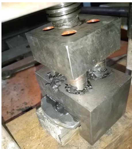
Рис. 1. Лабораторный пресс штемпельного типа
