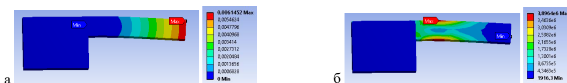
Рис. 2. (а) Деформированное состояние непосредственной кровли (б) Напряженное состояние перед хрупким разрушением
