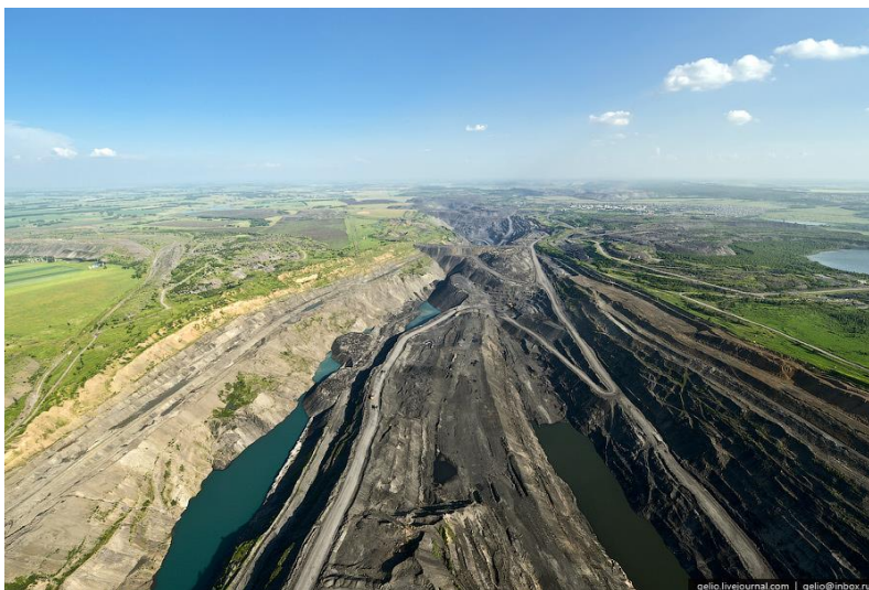
Рис. 3. Общий вид углубочной продольной системы разработки на примере разреза «Бачатский»
