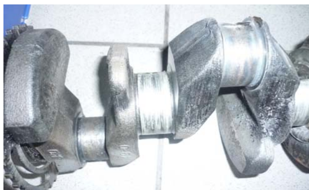
Рис. 2. Приваривание вкладышей к шатунной шейке коленчатого вала
