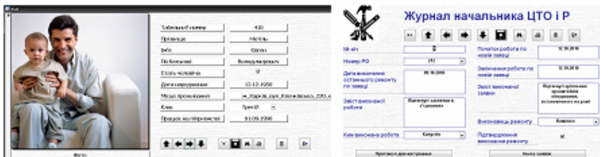
Рис. 3. Примеры форм разработанной базы данных для работы АРМ инженера участка предприятия по ремонту механического оборудования городского транспорта
