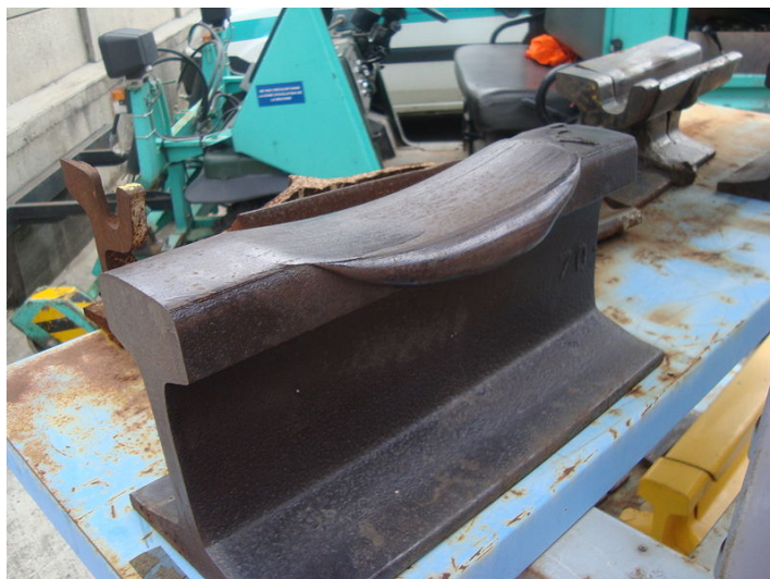
Рис. 5. Фрагмент рельса поврежденного боксованием ведущего колеса локомотива
