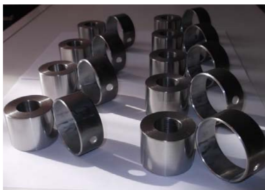
Рис. 2. Образцы для испытаний на машине трения СМТ-1
