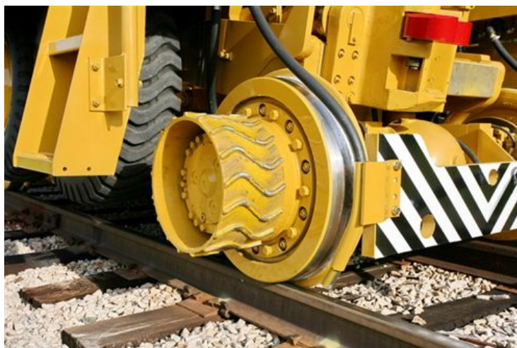
Рис. 4. Приводной барабан на ступице колеса рельсового хода трэкмобиля
