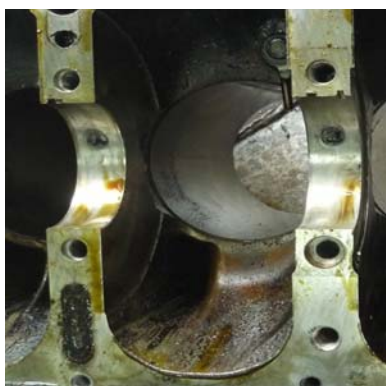
Рис. 1. Отложения в каналах масляной системы
