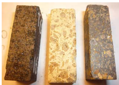
Рис. 2. Вид образцов, с лева на право: исходный; нагретый в атмосфере воздуха; нагретый в кварцевой трубке
