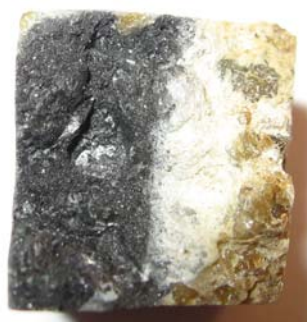
Рис. 3. Образец, наполовину обработанный защитным покрытием и разогретый
