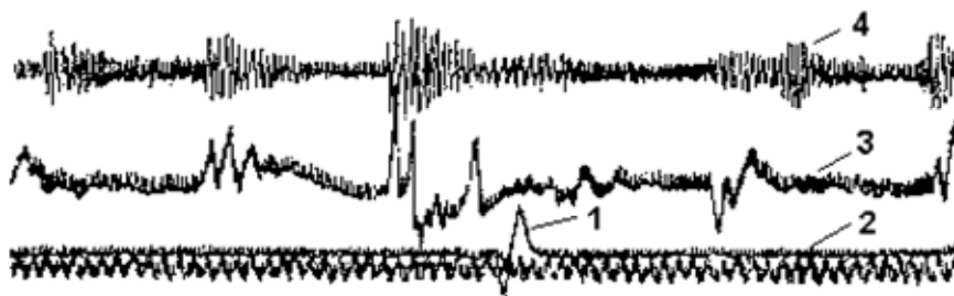
Рис. 1. Осциллограммы характерных вибрационных сигналов, зафиксированные при работе двигателя внутреннего сгорания без нагрузки:
