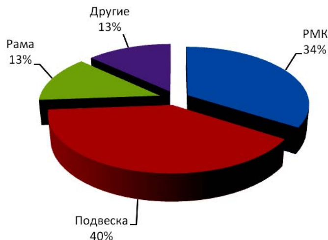
Рис. 1. Распределение отказов по элементам несущей системы
