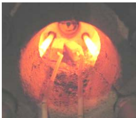
Рис. 1. Экспериментальный разогрев образцов в электропечи.
