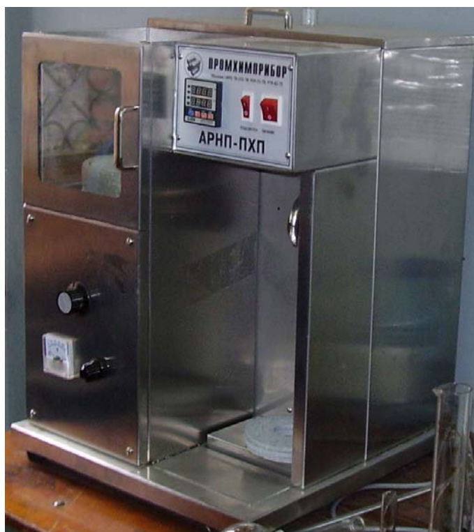
Рис. 5. Установка для определения фракционного состава бензина «АРНП-ПХП»
