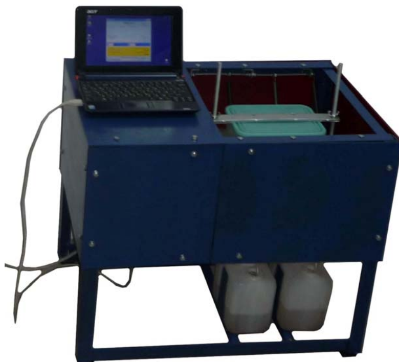
Рис. 1. Новый вибрационный станок с автоматизированным циклом обработки
